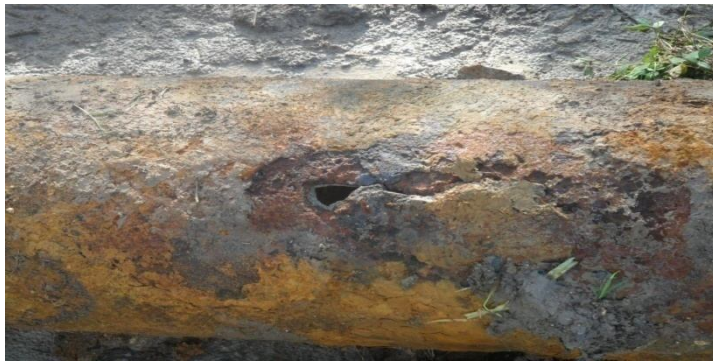
Figure : Casse accidentelle occasionnée par un engin sur conduite DN 200
